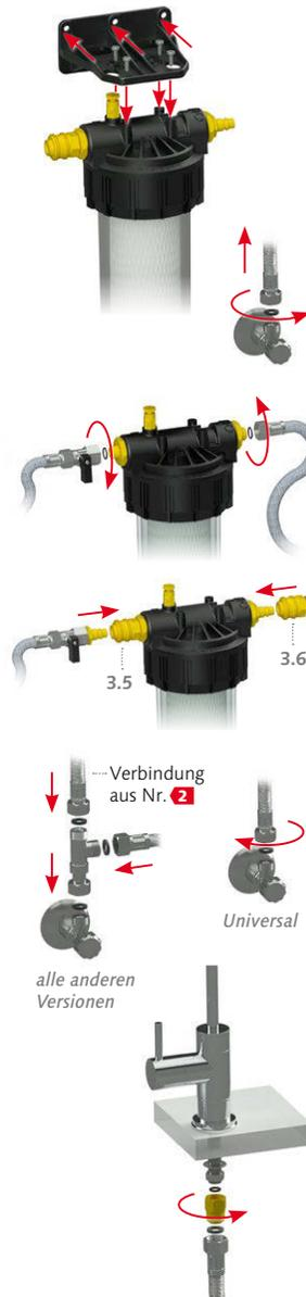
**1** Die Wandhalterung 1.2 mit geeignetem Material (Dübel, Schrauben) an der Wand befestigen, wegen der Abnehmbarkeit die Schrauben nicht zu fest ziehen und anschließend das Filtergerät am Filterkopf 1.1 mit dem beiliegenden Schraubensatz 1.6 am Wandhalter befestigen.
