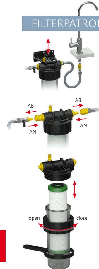
**7** Kugelhahn B schließen und Wasserhahn C öffnen. Bei Varianten mit verschraubten Schläuchen (Classic) das Filtergehäuse 1 mit der Wandhalterung 1.2 von der Wand abnehmen um den Filterpatronenwechsel unter der Spüle auszuführen.
