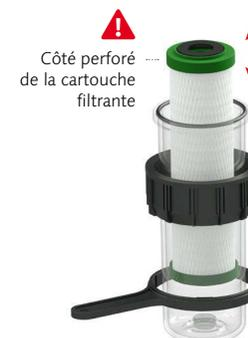
**8** Sortez les cartouches filtrantes usagées et insérez les nouvelles cartouches, puis réassemblez le tout dans l'ordre inverse. **Important** : Le côté de la cartouche filtrante (couverture de connexion), muni d'un joint torique et perforé à l'intérieur, doit être orienté vers le haut lorsqu'il est inséré dans le bol filtrant.
